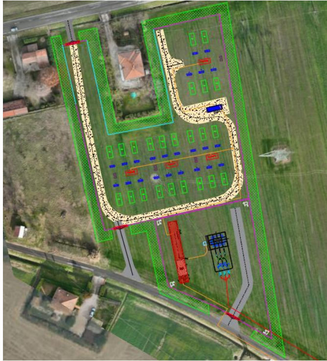
Figura 9: Sistema di accumulo e Sottostazione elettrica utente
